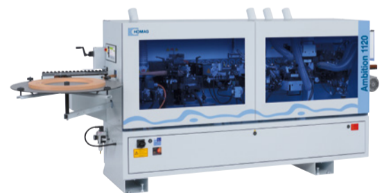
Die Einsteigermaschine Ambition 1120 F mit voller Automatisierung auf unter 6 m 2
