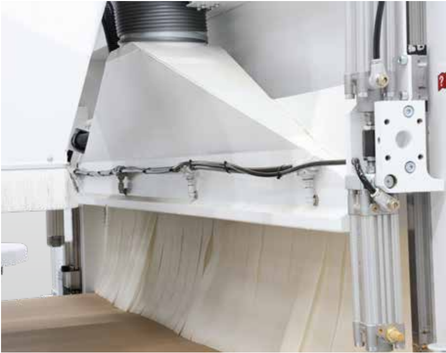
Aspirazione all'estremità del nastro
