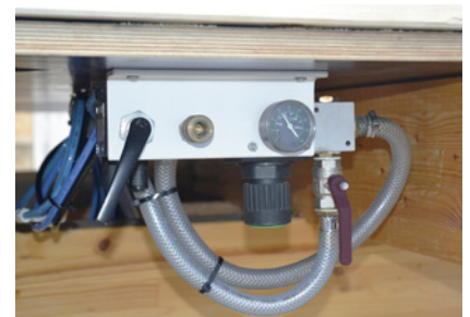
Zestaw pneumatyki do centralnego zasilania powietrzem i sterowania belką mocującą C-PowerTec
