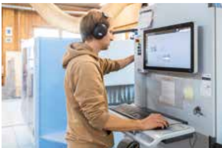
CNC-Bearbeitung: Nun erfolgen Formatierung und Bearbeitung der Werkstücke auf dem Bearbeitungszentrum HOMAG Venture 316 L CNC 5-Achs.
