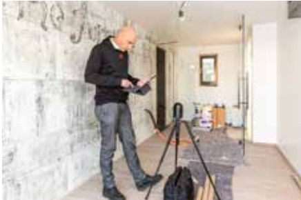
Massaufnahme: Per Raumscanner von Leica werden vor Ort der Raum oder das Objekt innert weniger Minuten millimetergenau vermessen.
