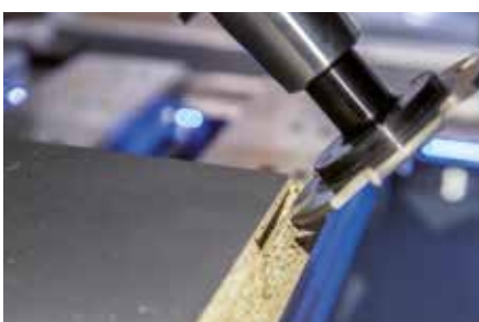
P-System: Profilnut-Fräsung mit der HOMAG Venture 316 L CNC 5-Achs.
