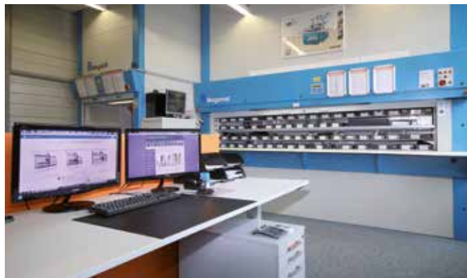
Werkstattbüro mit Hochregallager für Ersatzteile zu Stationärmaschinen.
