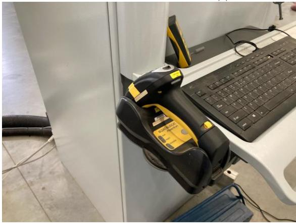
Дает возможность задавать последовательность изготовления путем считывания штрих-кода
