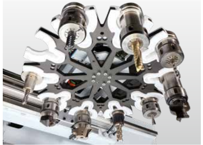
10-násobný tanierový menič unášaný na vretene. Výmena nástroja počas vrtania alebo olepovania hrán. Pre nástroje a agregáty s priemerom do 180 mm.
