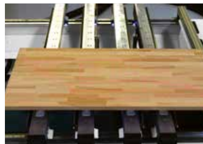
Laserová projekcia upínacieho prostriedku a kontúry obrobnku pre optimálne využitie a jednoduché umiestnenie polotovarov, ktoré nie je možné vyrovnáť na dorazoch.
