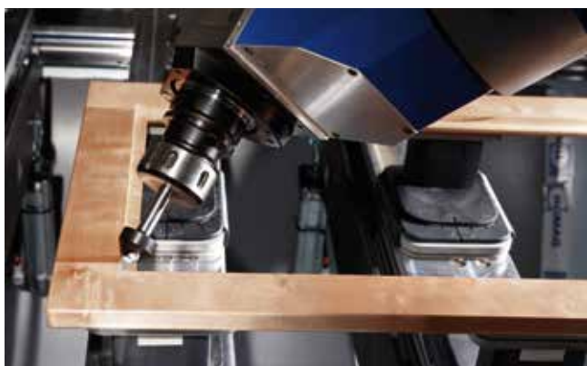
Frézovanie rohu skleneného rámu
