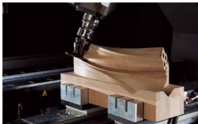
Frézovanie schodiskového držadla
