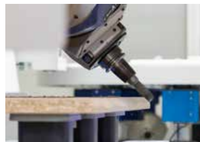
Affleurage avec palpage des dépassements de chant sur des profils postformés
