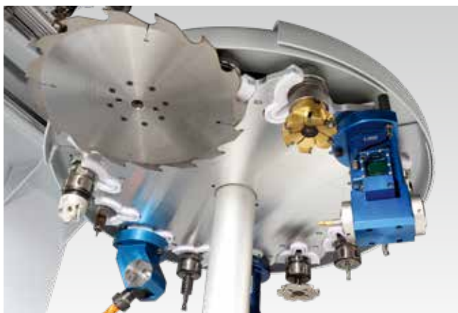
Changeur d'outils à disque à 14 emplacements pour les outils et agrégats d'un diamètre maximal de 200 mm et les lames de scie d'un diamètre maximal de 350 mm.
