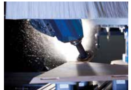
Fraisage de rainures à bords biseautés pour l'assemblage de panneaux
