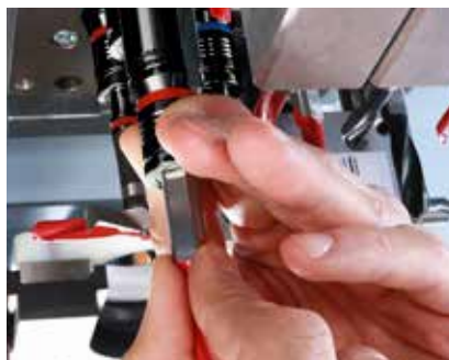
Système de changement rapide breveté pour un changement de mèche sans outils afin de réduire les temps de réglage.
