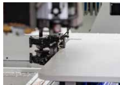
Finition parfaite des chants grâce à l'agrégat combiné d'affleurage et de raclage
