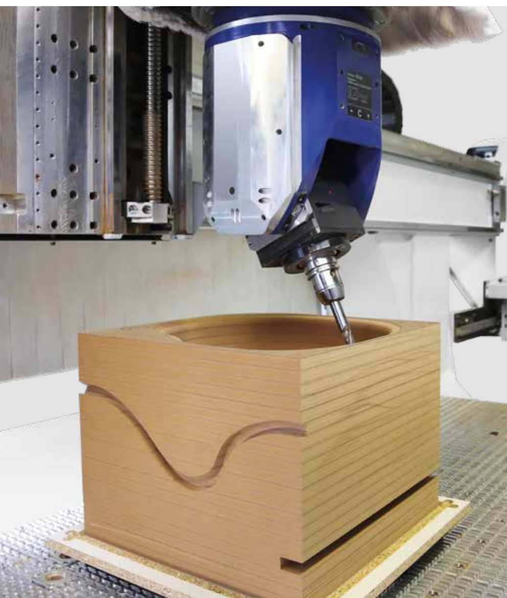
Fraisage de composants avec une hauteur Z élevée
