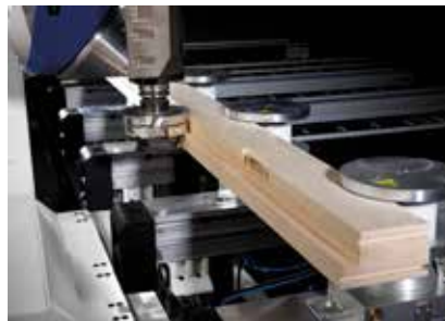
Profilage d'éléments de cadre
