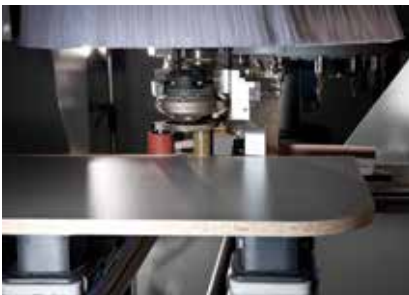
Agrégat d'encollage easyEdge pour un encollage rationnel des pièces de forme
