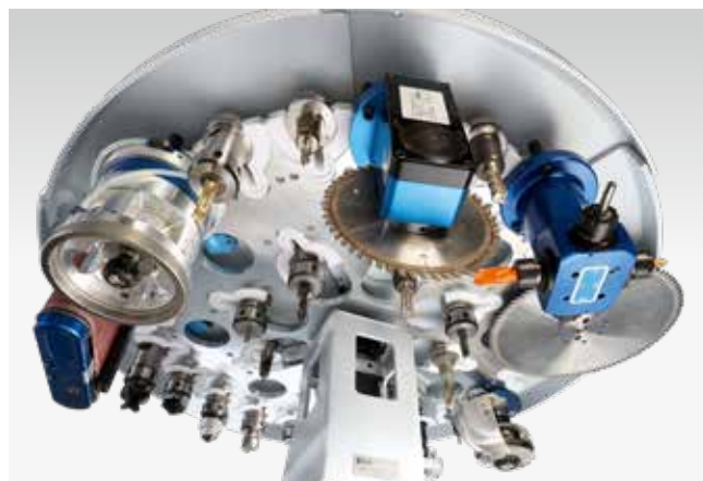
Changeur d'outils à plateau à 32 emplacements (24 emplacements). Disposition des outils dans une bague intérieure et une bague extérieure. Pour les outils et agrégats d'un diamètre maximal de 200 mm et les lames de scie d'un diamètre maximal de 350 mm (dans la bague extérieure).
