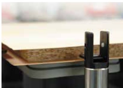
2 Doigt de butée pour le dépassement de la couche de revêtement
