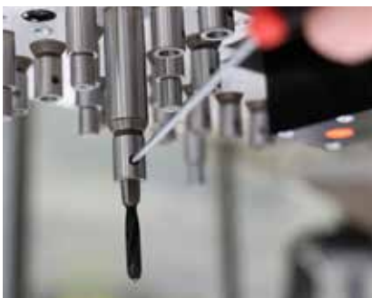
Système de changement Weldon pour un changement de mèche avec outils
