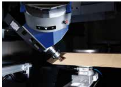
Fraisage de raccord d'arêtes pour structures de poteaux/barres
