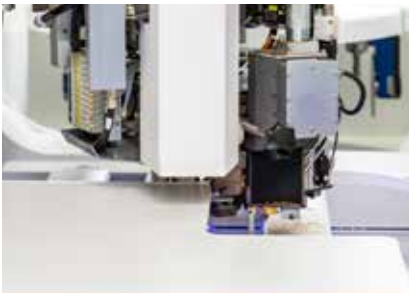
Encollage des chants à 360° avec l'agrégat d'encollage des chants powerEdge Pro Duo
