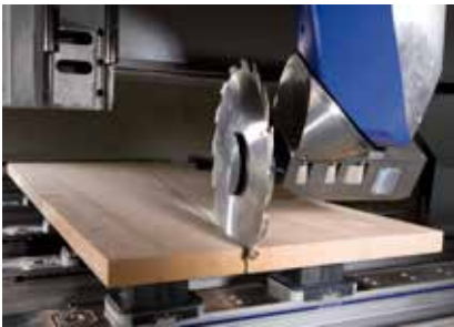
Sections de coupe d'une hauteur maximale de 110 mm
