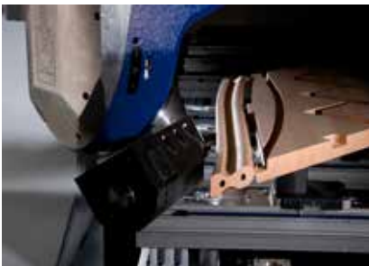
Perçages pour lattes dans un angle étroit
