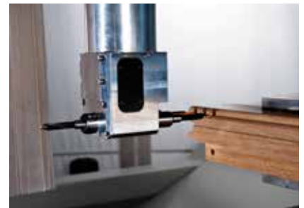
Assemblage par tourillons précis
