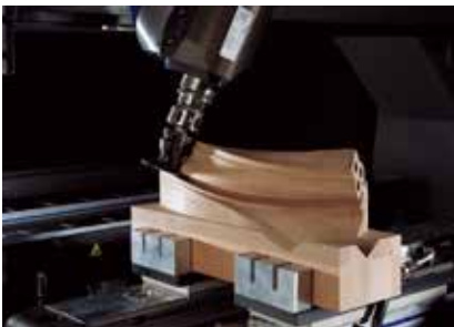
Fraisage d'une main courante d'escalier
