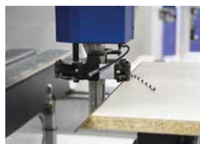
Usinage par raclage par rapport au chant de l'onglet
