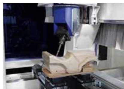
Usinage à interpolation de pièces de forme libre
