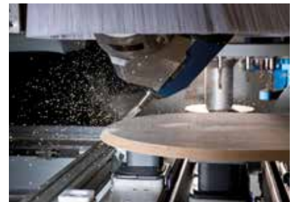
Fraisage de chanfrein sur un dessus de table
