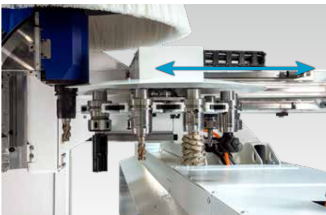
Changeur d'outils à disque à 10 emplacements embarqué par la broche. Changement d'outil pendant le perçage ou l'encollage de chants. Pour les outils et agrégats d'un diamètre maximal de 180 mm.
