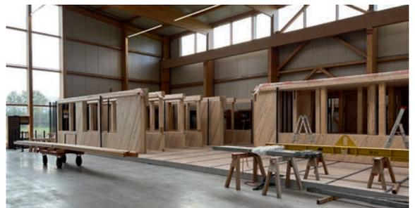
**Nachher:** Die Wandelemente können im Rungenlager schnell und einfach positioniert und ausgerichtet werden.
