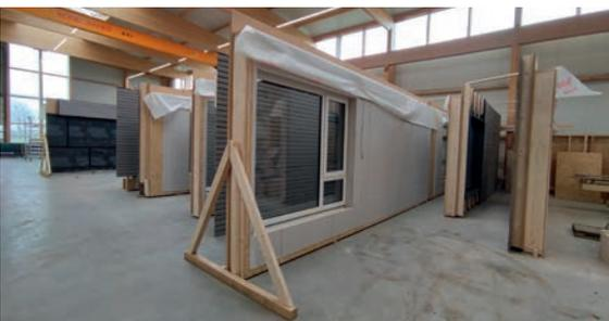
**Vorher:** Die Wandelemente werden frei im Raum behelfsmäßig befestigt. Der Aufbau der Wandelemente und die exakte Ausrichtung für den Fenstereinbau kosten viel Zeit und Mühe.
